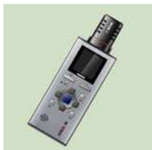
Nagra Ares M avec micro intégré 125x53x22 mm, 200gr.
